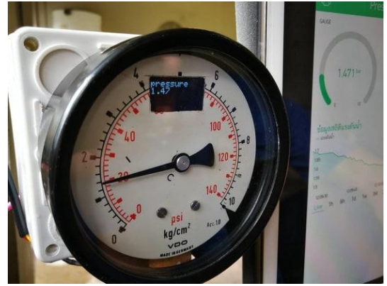
เครื่องบันทึกแรงดันน้ำชนิดพกพา พร้อมรายงานผลผ่านระบบ IOT Logger (Portable IOT Smart Logger) ต้นแบบ
